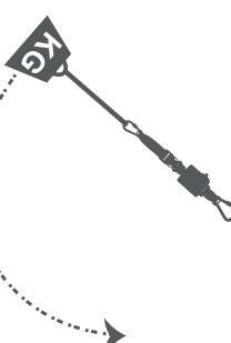
Se une el lanyard a un punto de anclaje y al otro extremo se le aplica la carga. Se eleva la carga por encima del punto de anclaje y se suelta, 5 veces.
