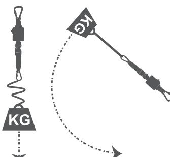
Se une el lanyard a un punto de anclaje y al otro extremo se le aplica la carga. La carga se eleva y se suelta verticalmente, 5 veces.
